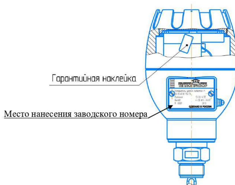
Рисунок 2 – Схема пломбировки от несанкционированного доступа, место нанесения паспортной таблички с указанием места нанесения заводского номера
